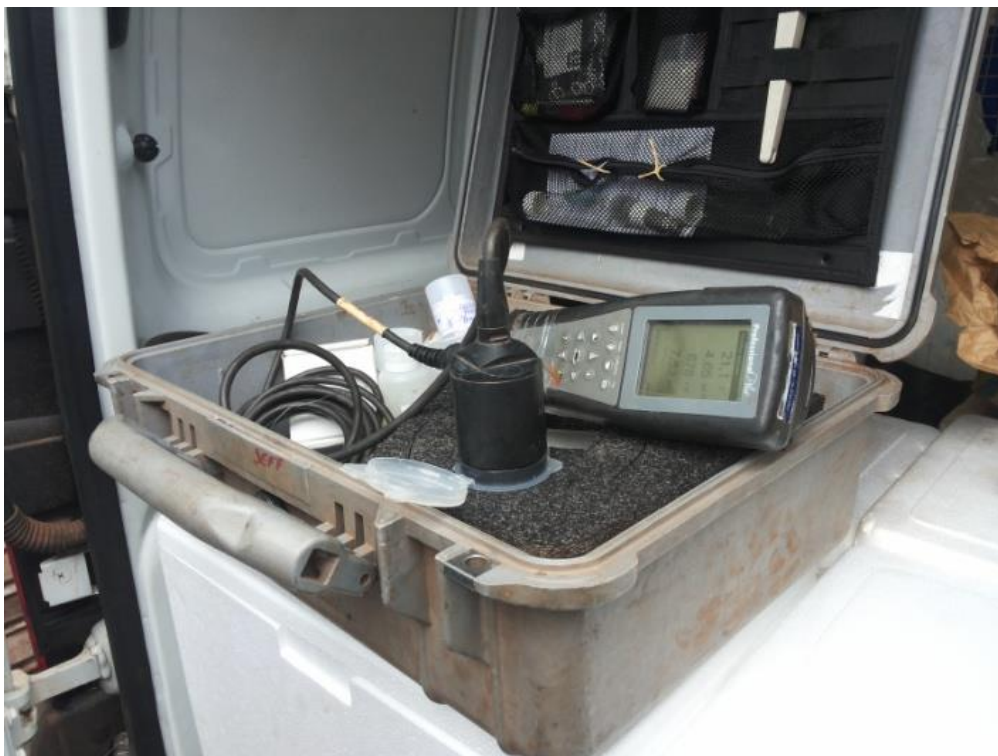
Figura 6: Equipamentos para análise de parâmetros de qualidade da água in loco.
