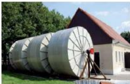
Rathewalde (Germany), 1.000 PE rehabilitation – Ø 3,9 m disks
