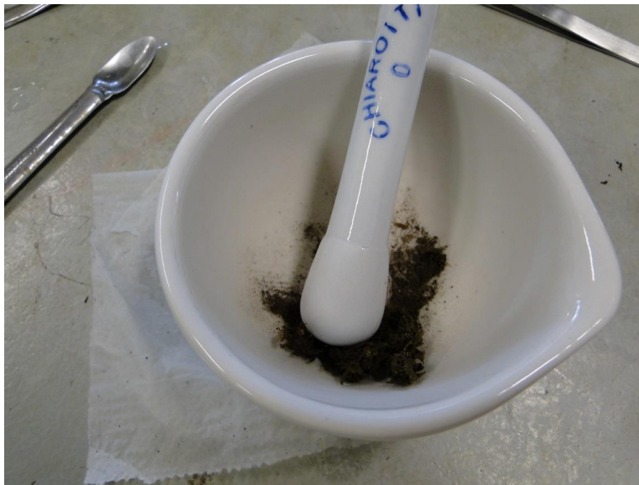
Figura 231. Processo de moagem de material seco, em cadinho com pistilo Fonte: dos autores (Fevereiro, 2016)
