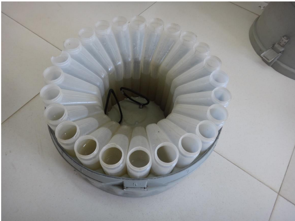
Figura 109. Amostrador automático com 24 parcelas coletadas a cada hora.
