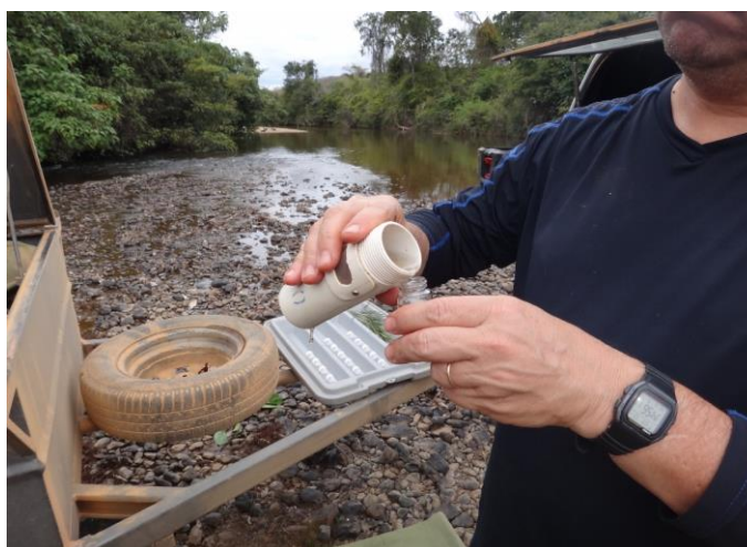
Figura 97. Acondicionamento de amostra de água filtrada em frasco, no ponto de coleta do rio Pardo Pequeno (PP-01)
