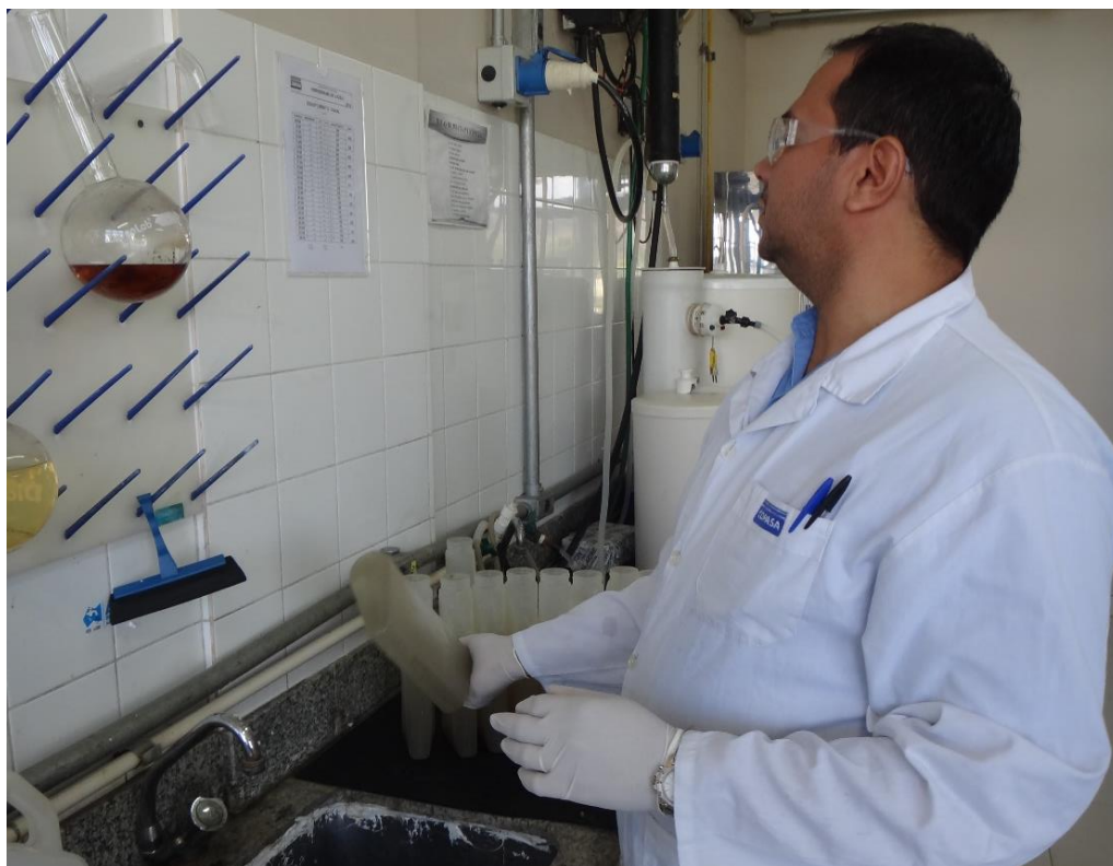
Figura 110. Amostra sendo agitada para separação da sub-parcela proporcional à vazão afluyente na ETE no momento da coleta.
