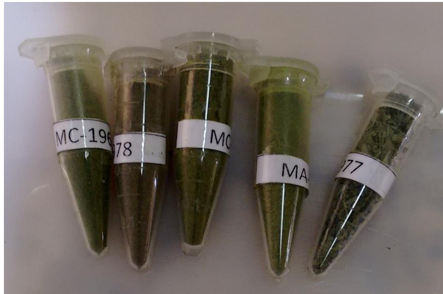
Figura 116. Grupo de amostras vegetais dessecadas, liofilizadas e maceradas, acondicionadas em frascos Eppendorf para análises de isótopos estáveis.
