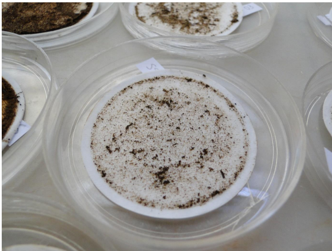
Figura 233. Amostras filtradas de perifíton e material em suspensão na água. Detalhe dos filtros de fibra de vidro Millipore® de 45 micrômetros
