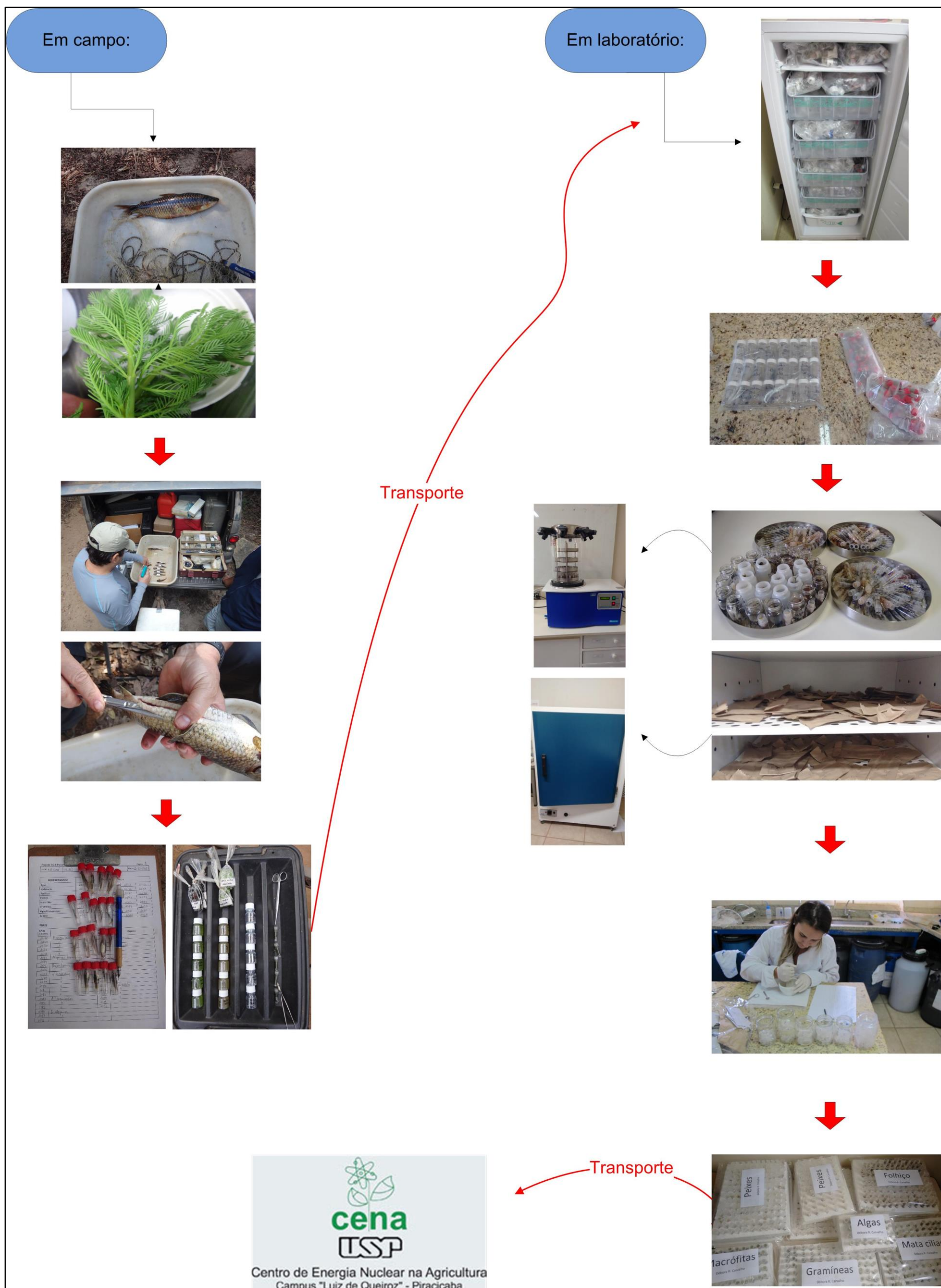
Figura 118 - Esquema ilustrado do processamento de amostras de isótopos estáveis, desde a coleta até o fim das análises que gerarão os valores para interpretação matemática e estatística.
