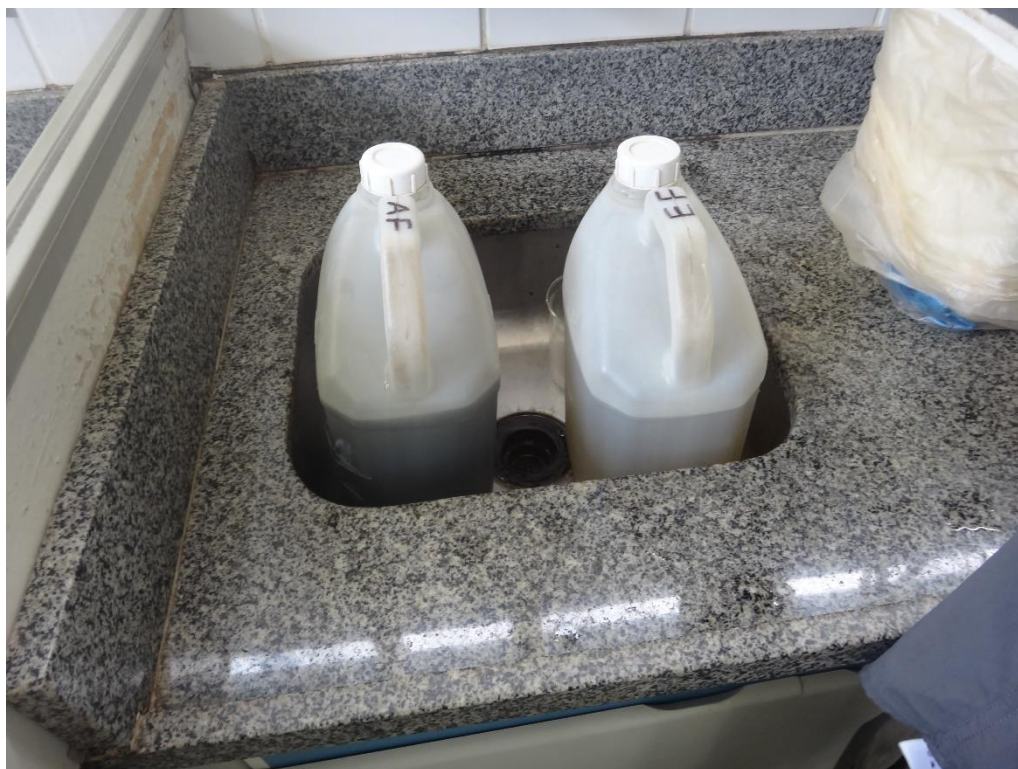
Figura 112. Amostras compostas, após a coleta de todas as 24 sub-amostras
