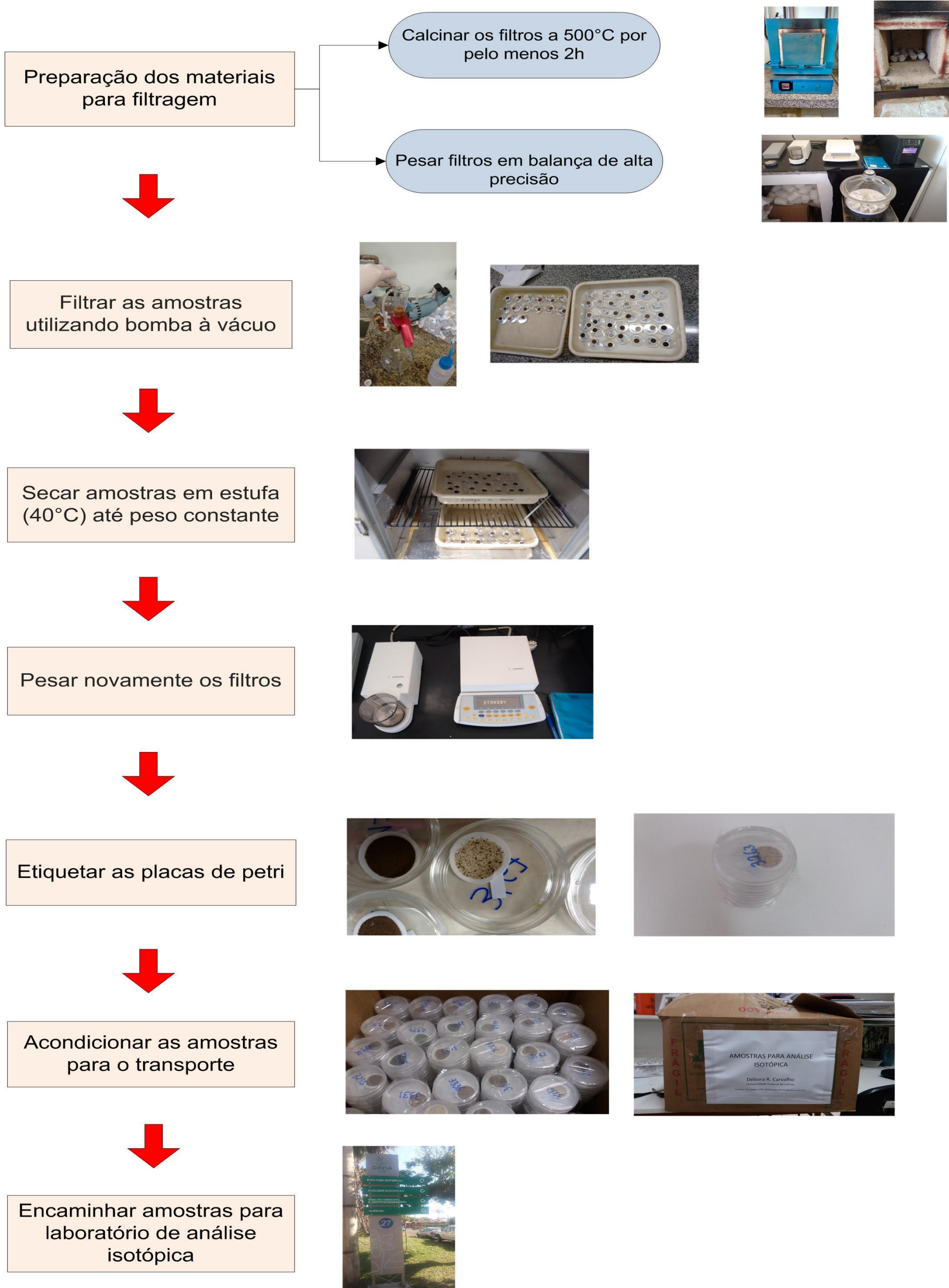
Figura 119 - Esquema ilustrado do processamento de amostras líquidas de isótopos estáveis, em laboratório.
