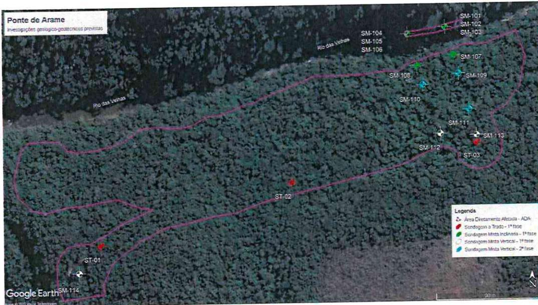
Além das investigações diretas indicadas na Figura 1.2.5.2. acima, a Vale realizará levantamento geofísico de eletrorresistividade e sísmico para as margens direita e esquerda do barramento. Abaixo apresentamos a Figura 1.2.5.3 com a locação preliminar das linhas geofísicas.
