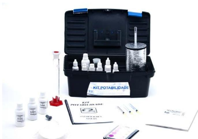
Figura 1: Kit técnico de potabilidade da empresa ALFAKIT utilizado para análise de parâmetros físico-químicos e microbiológicos.
